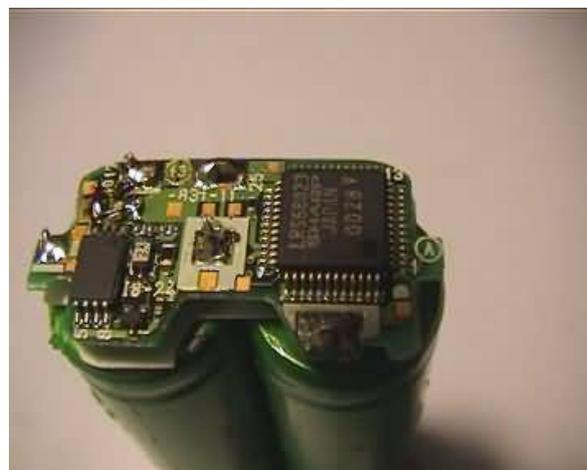
Se observa la placa con el procesador ( de Sharp ) y los circuitos de medida de consumo ( "gas gauge" ). Realmente, estos tíos se han comido mucho el coco para obtener resultados un poco decepcionantes.
