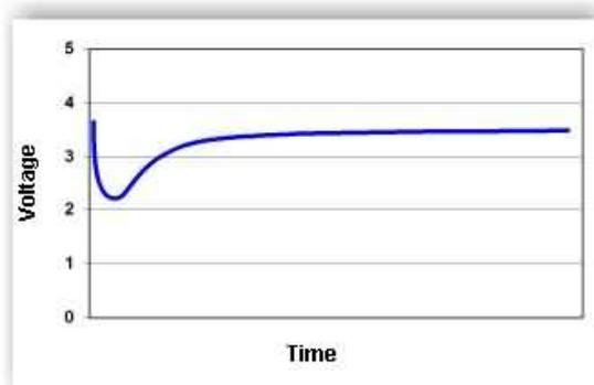
Conforme la batería va siendo usada, esta fina película va desapareciendo. El problema está en que la caída de tensión puede ser lo suficientemente abrupta como para que la cámara de video se apague. Cuanto mayor sea la energía requerida al principio, más acusado puede ser el problema. Cuando dejamos de usar la batería, la película vuelve a irse formando.
