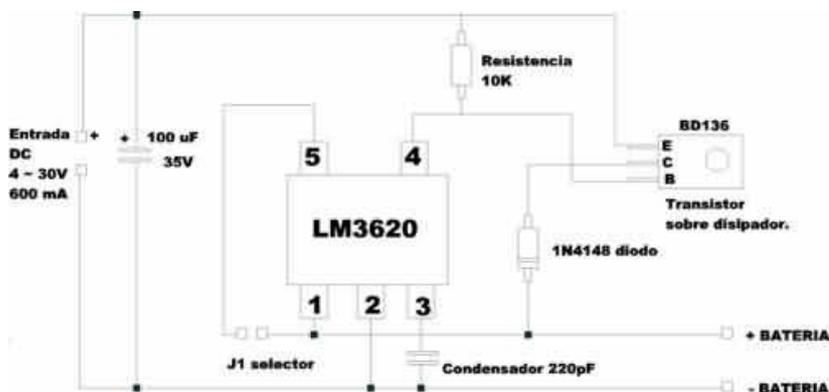
Es muy sencillo y se puede montar sobre una pequeña placa de plástico o de circuito impreso para prototipos. Hay que ser un poco manitas y usar un soldador de baja potencia ( 25W ). **Yo no lo he probado y tengo ciertas dudas sobre el transistor elegido.**
