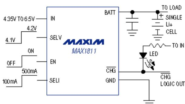
Como veis solo se necesita un condensador de salida ( en paralelo con la batería ) de 3.3 uF / 35V . Como "lujo", se puede poner un diodo luminoso ( LED) indicador de fin de carga. Precisa una resistencia de 620 ohmios ( en el caso de que la alimentación de entrada sea de 5V, en otros casos habría que echar cuentas sabiendo que la tensión en el diodo debe ser de 2.1V y la corriente de 5 mA ).  $R = V / I \rightarrow R = ( V_{in} - 2.1 ) / 0.005$
