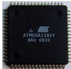
Fotografía del microcontrolador utilizado por la sonda *Meteotek08*.
