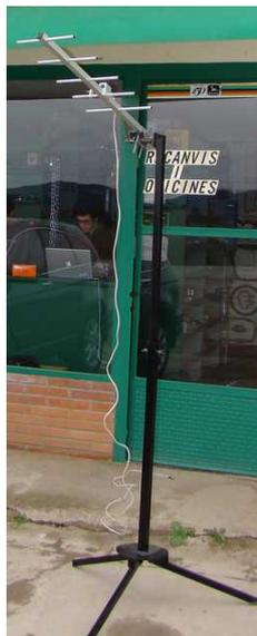
*Antena direccional utilizada en la base de recepción*
