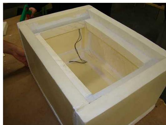
*Proceso de construcción de la caja con porexpan de alta densidad y el resultado al lado*
