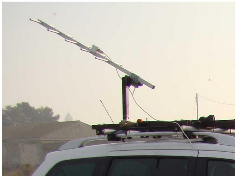
Los dos soportes de antena, el fijo y el móvil
