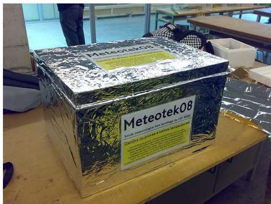
*La jaula metálica y la caja totalmente acabada*
