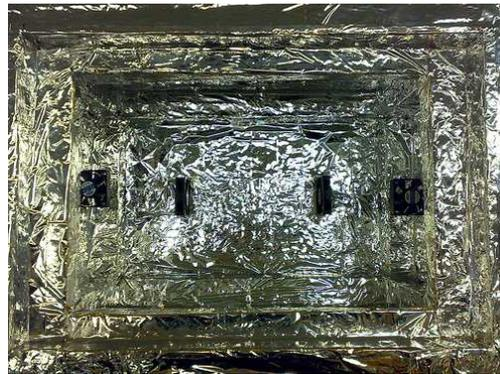
*Los 4 ventiladores instalados en el interior de la caja de pruebas*
