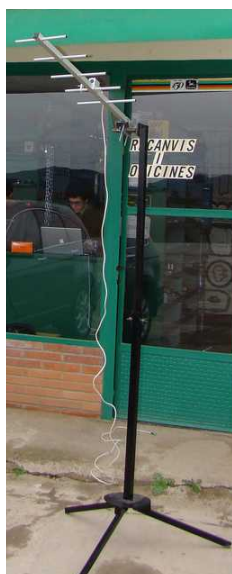
Antena direccional utilitzada a la base de recepció
