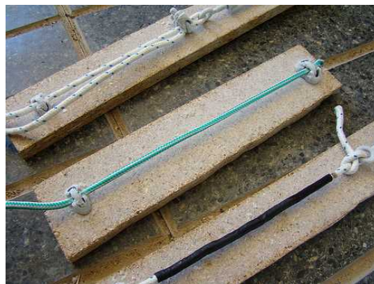
Introducció del gel sec i de les cordes després d'haver passat la prova de fred
