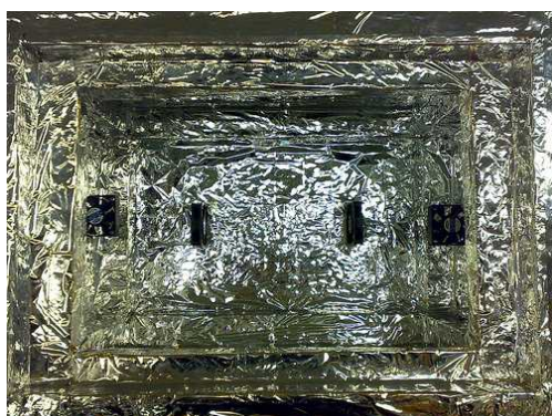
Els 4 ventiladors instal·lats a l'interior de la cambra de proves
