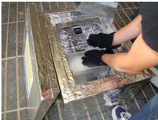
Introducció del gel sec i de les cordes després d'haver passat la prova de fred
