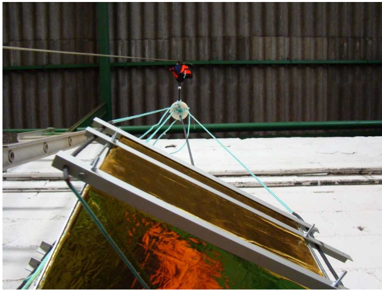
Fent les proves d'anivellament amb les cordes i el punt d'unió
