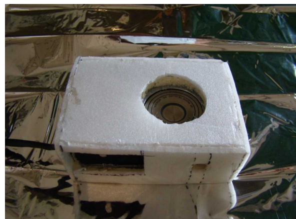
Fotografia amb el servomotor i la càmera aïllats utilitzant diversos tipus de porexpan
