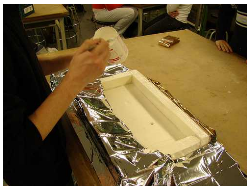
Encolant la manta tèrmica i el resultat al costat
