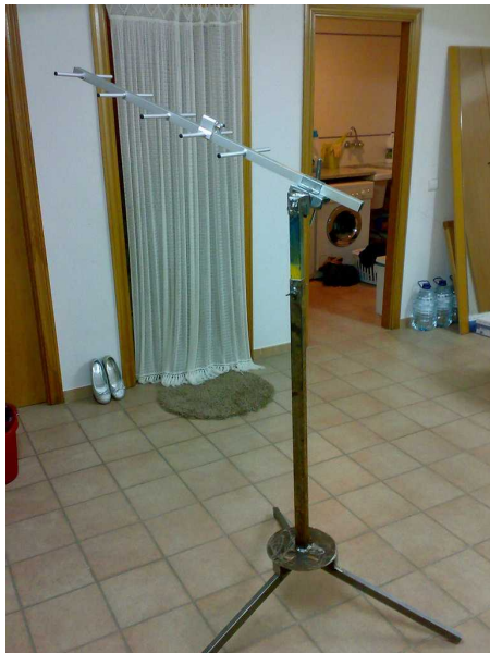
Els dos suports d'antena: el fix i el mòbil
