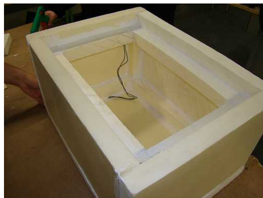
Procés de construcció de la caixa amb porexpan d'alta densitat i el resultat al costat
