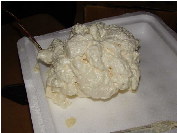
Moment de l'aplicació de l'escuma expansiva i posterior resultat
