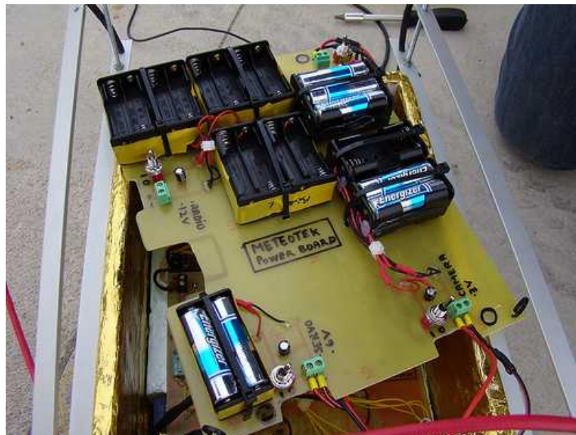
Placa d'alimentacions amb els 4 blocs clarament identificats
