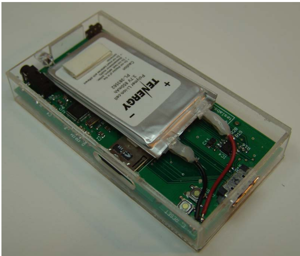
Gener 2008: La carcassa de metacril·lat amb el reproductor final (part de darrera)
