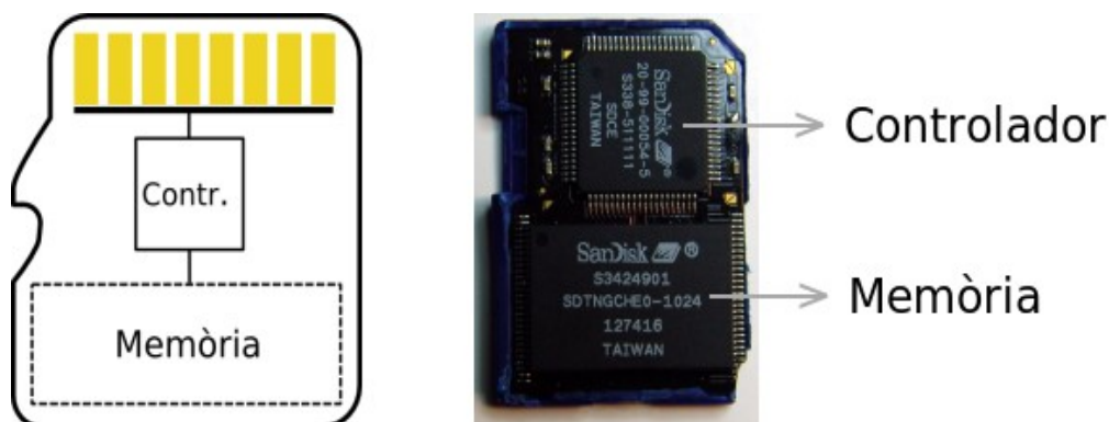
Il·lustració 2.6: Interior d'una targeta microSD i SD respectivament
