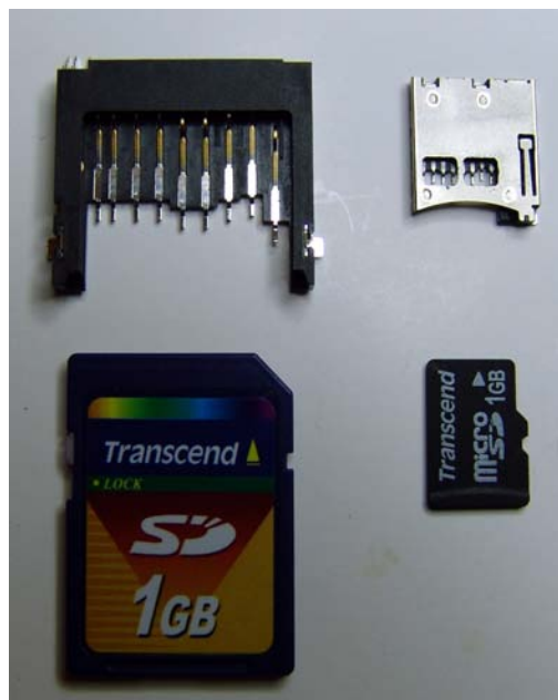
Il·lustració 2.5: Comparació de tamany entre una SD i una microSD
