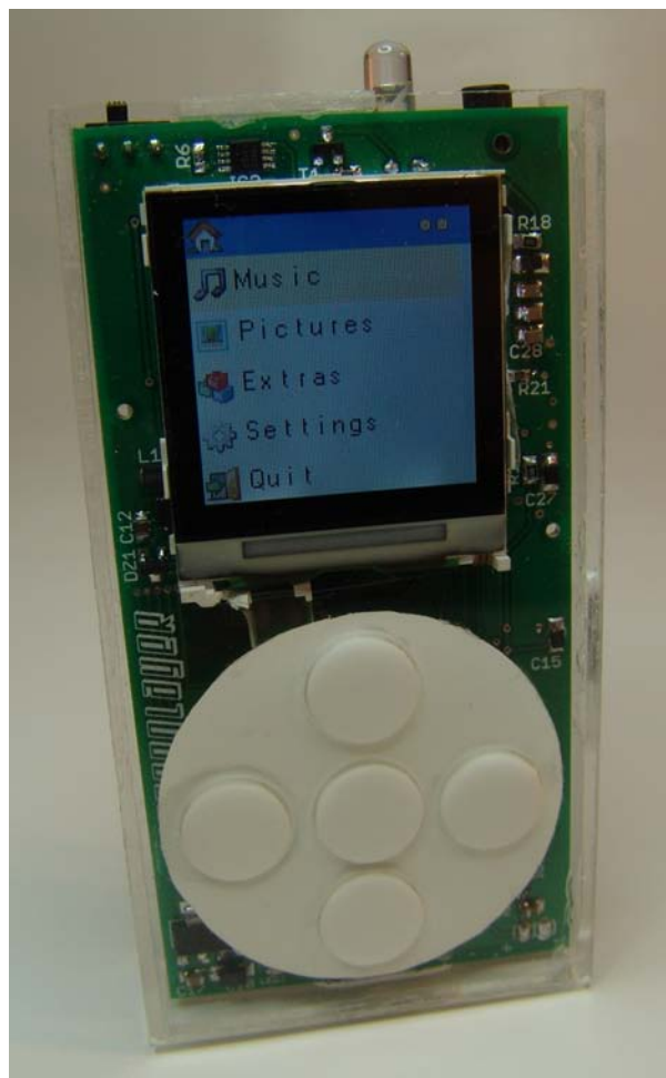
Gener 2008: La carcassa de metacril·lat junt amb el reproductor final
